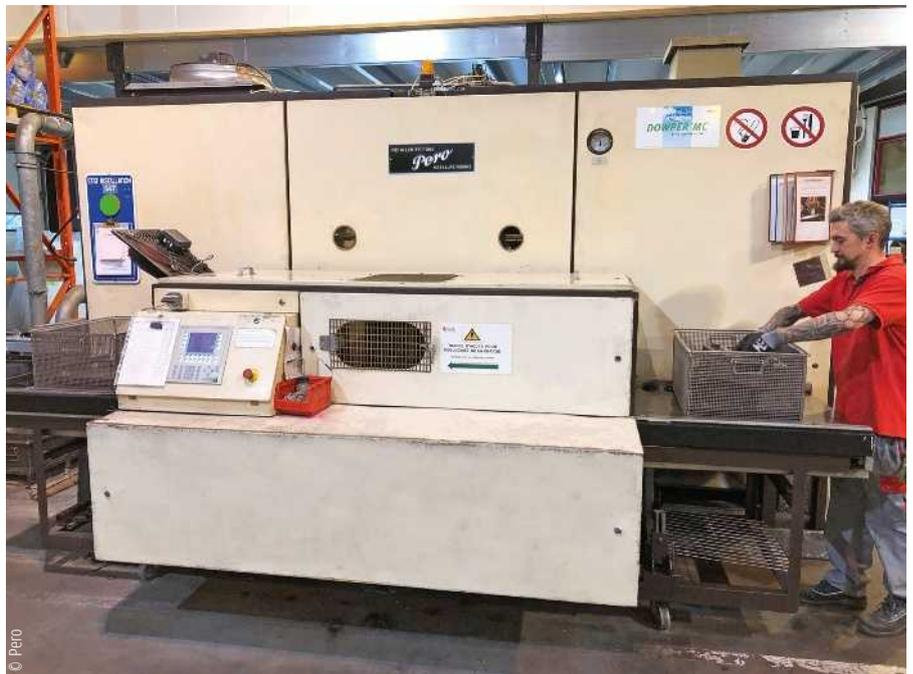
Sur le site de Besançon, l'installation Pero adopte un chargement automatisé des paniers positionnés sur un tapis de convoyage.
