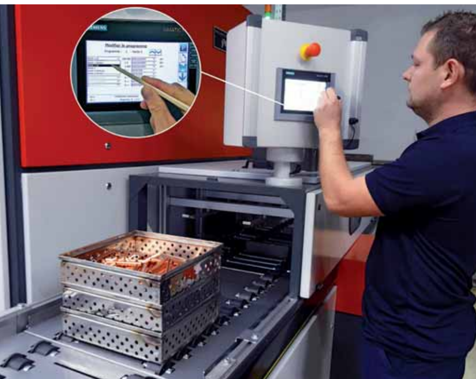
L'opérateur dispose de plusieurs menus étudiés en fonction des typologies de pièces à nettoyer.
