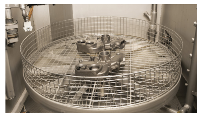
Panier de lavage rotatif avec buses d'aspersion et de vidange
